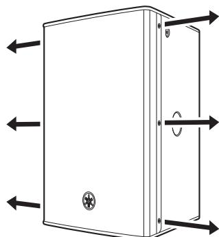
2. 使用2号十字头螺丝刀，拆下号筒上的所有螺丝，并将号筒从音箱中拉出。
