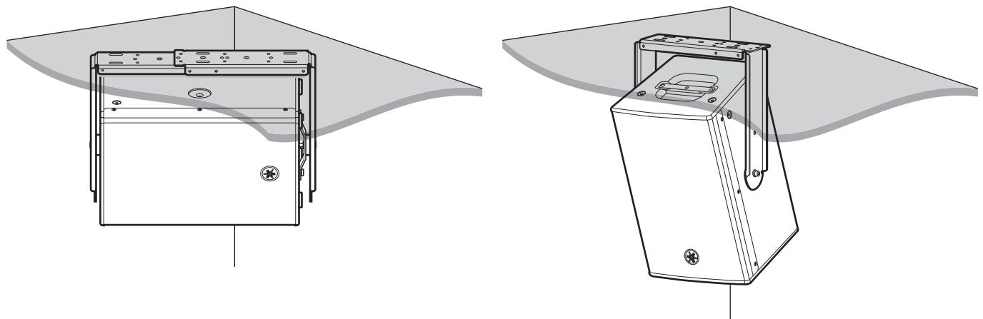
可使用另售的Yamaha UB-DXRDHR10 U型支架将DHR10以水平或垂直方向安装到天花板或墙壁。有关安装U型支架的说明，请参见相应的UB-DXRDHR10使用说明书。
