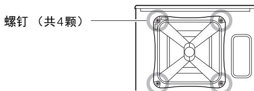
3. 90°旋转号筒，将号筒重新安装至音箱内，反向操作上述步骤。
